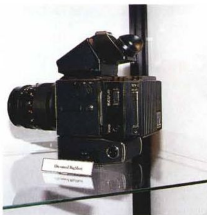
BigShot è il dorso Dicomed dotato di sensore CCD da 16 milioni di pixel.
